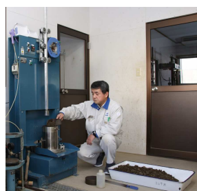
自動締め試験状況
