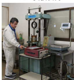
CBR試験状況
